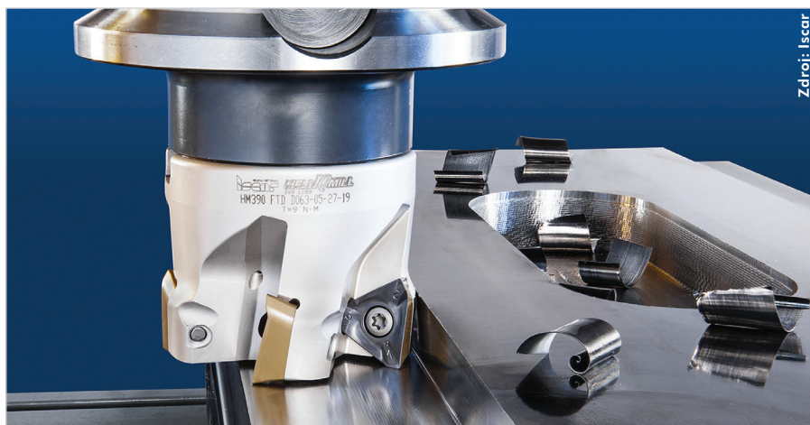
Obr. 2. Čelní nástřčná fréza z řady Heli-3-mill s trojřeznou trojúhelníkovou destičkou HM390 TDKT s řeznou hranou ve šroubovici.
