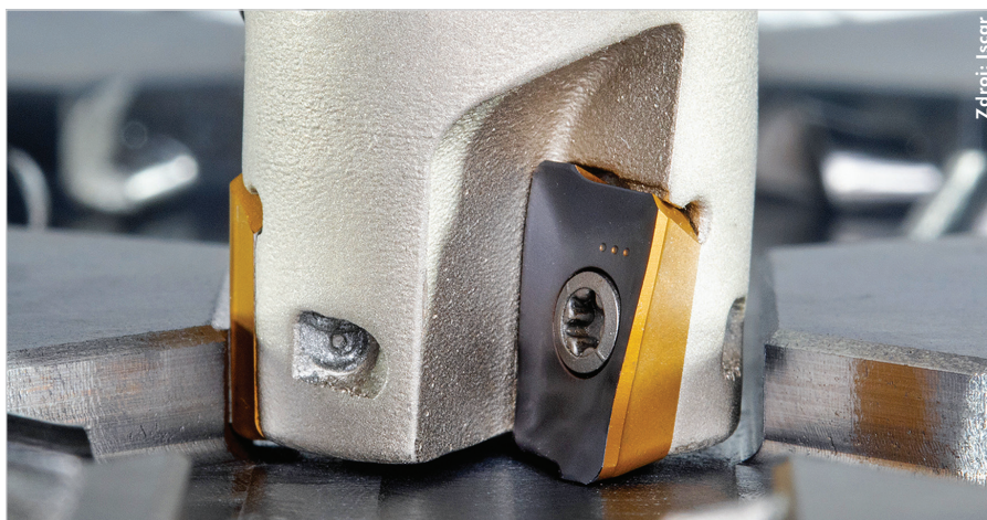
Obr. 1. Typická destička ve tvaru rovnoběžníku s řeznou hranou ve šroubovici vychází z řady Helimill. V tomto případě se jedná o destičku HM90 APKT.
